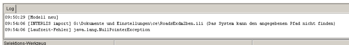
Abbildung 7.2: Logbereich nach dem eine INTERLIS-Modelldatei importiert wurde.
